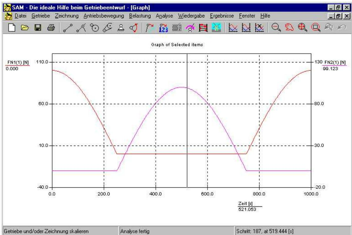
**Zugkräfte FN1 in oberem Riemenabschnitt und FN2 in unterem Riemenabschnitt (Achtung: versetzte y-Achsen)**
