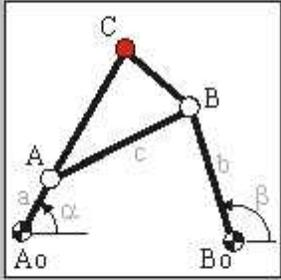
Erstellung eines 4-Gelenkgetriebes mittels Definition der Gelenkpunkte.
