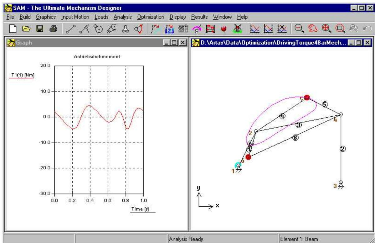
**Optimierter Mechanismus (a. Antriebsdrehmoment b. Mechanismus + Kompensationsmasse)**
