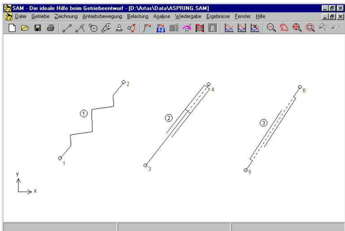
**Federelement, Stoßdämpfer und Reibungselement**
