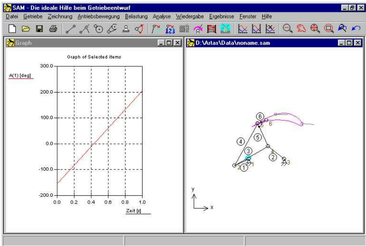
Ergebnis des Design Wizards "4-Gelenkgetriebe / 3-Lagen-Synthese (I)"
