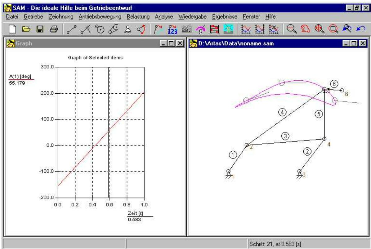
**Manuelle Verschiebung des Getriebes durch horizontale Mausbewegung über dem Graphfenster**
