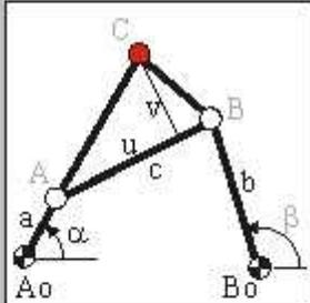
Erstellung eines 4-Gelenkgetriebes mittels Definition der Gestellpunkte  $A_o$ ,  $B_o$ , dem Kurbelwinkel  $\alpha$  und den Abmessungen  $a$ ,  $b$ ,  $c$ ,  $u$  und  $v$ .
